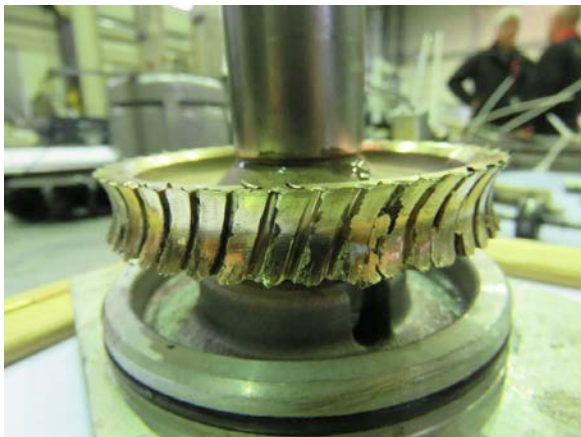
Abbildung 4: verschlissenes Schneckenrad Seildurchlaufwinde (Bildrechte: DEKRA)
