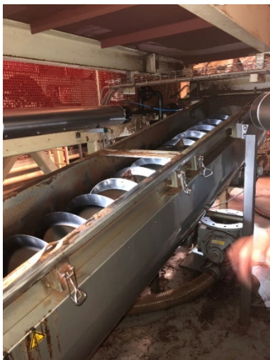
Abbildung 17: zugängliche Seite der Transportschnecke mit werkzeuglos zu öffnenden Schnellverspannungen ohne Sicherheitskontaktschalter; die Abdeckung ist entfernt
